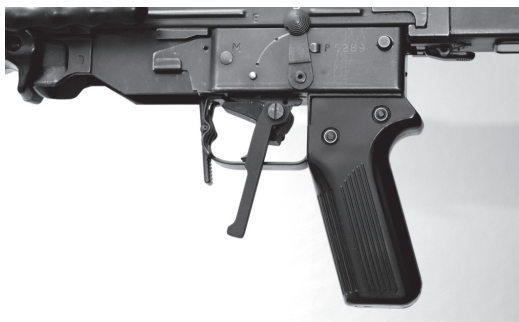
Bild 19: Winterabzug für Linksschützen zu Stgw 57
