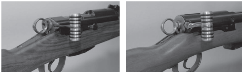
Bild 25: Riegelgriff anatomisch zu Karabiner und Langgewehr
