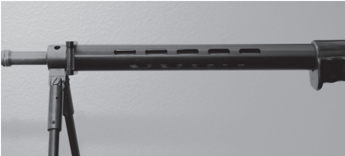
Bild 17: Mantelrohr zu Stgw 57
